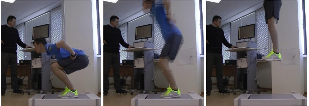
Рисунок 22 – Пример использования в спортивной подготовке прыгунов на лыжах с трамплина высокой квалификации упражнения «Вертикальный прыжок вверх из стойки разгона на тензоплатформе»
