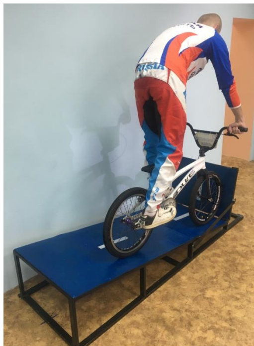
Рисунок 2. Отклонение велосипеда от центральной оси дорожки (то есть гонщик расположен параллельно центральной оси, но не по центру дорожки стартовых ворот)
